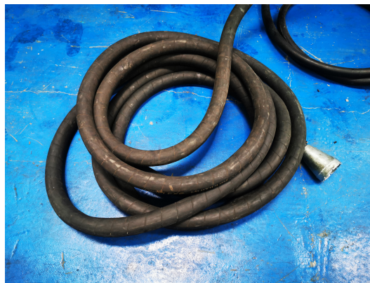
Figura 10: Manguera de 1.5in x 7m con terminación hembra JIC en un solo costado (acople Universal)
