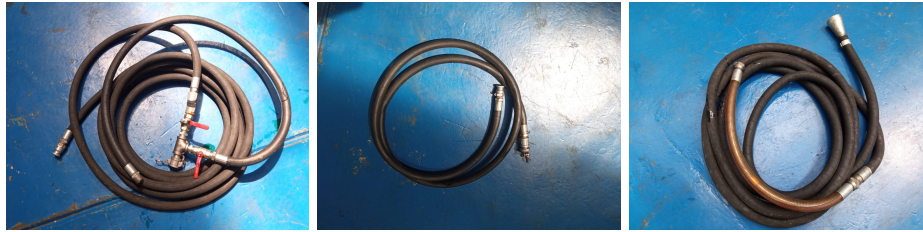
Figura 29: Mangueras desmontables (a) Descarga (b) Clarificado (c) Succión
