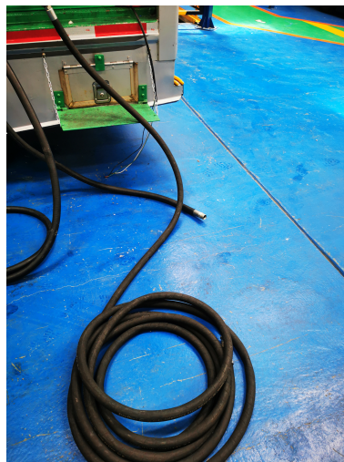
Figura 17: Manguera de 1in x 7m con terminaciones OPW (acople rápido)
