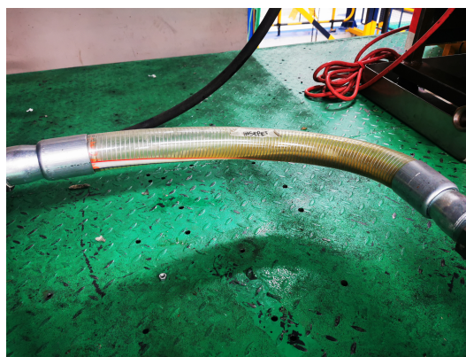
Figura 11: Manguera 1.5in transparente fija intermedia
