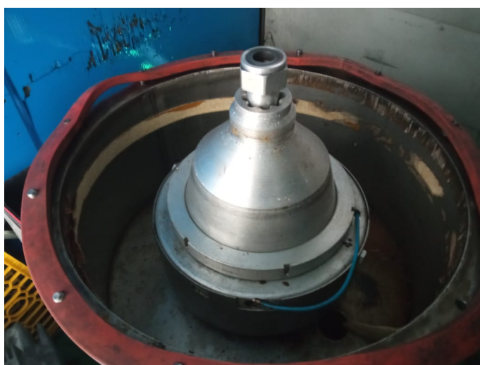
Figura 48: Montaje del aro de vibración y del conjunto rotatorio sin sombrilla
