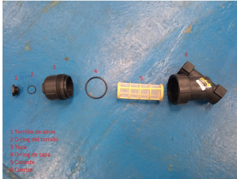
Figura 12: Filtro de paso en Y banjo con Malla filtrante de particulado mayor a 0.5mm
