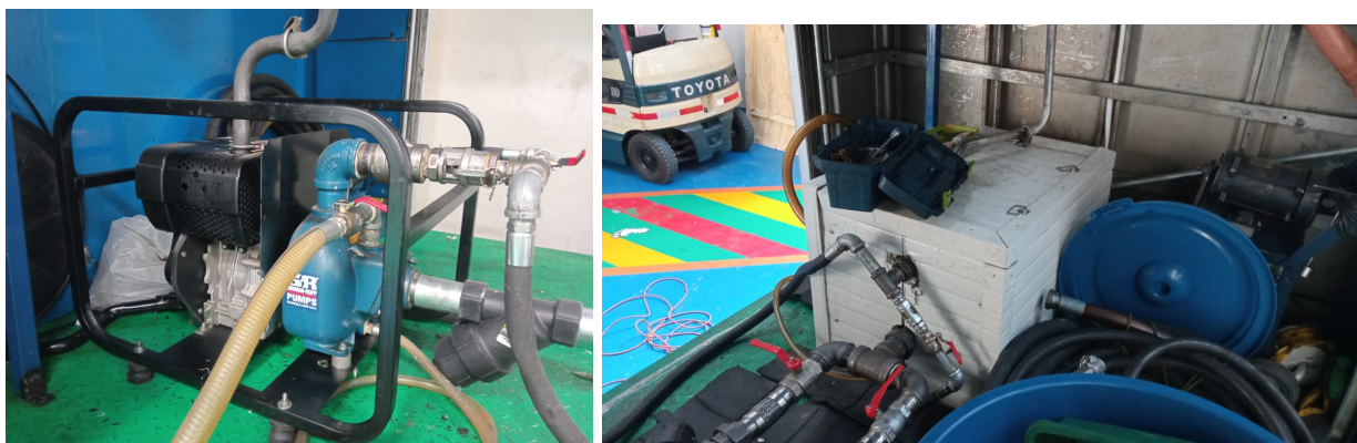
Figura 2: Bomba hidráulica GORMAN RUPP
