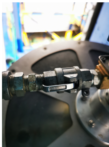
Figura 21: Sistema de acople hidráulico OPW reducción de 3/4in a 1/2in
