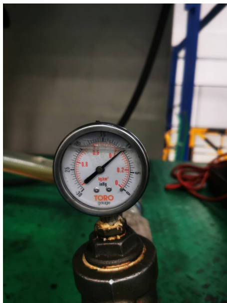
Figura 36: Vacuómetro de succión en 15 mm Hg
