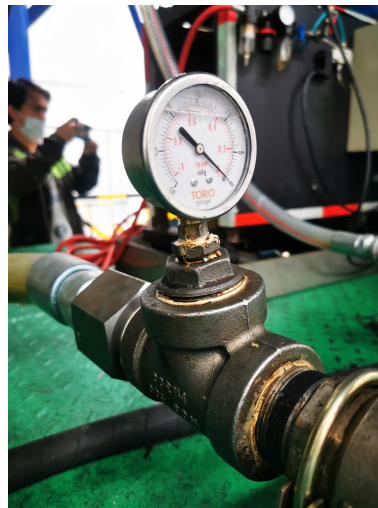
Figura 13: TEE hidráulica con vacuómetro 0 a -30 mmHg (milímetros de mercurio)
