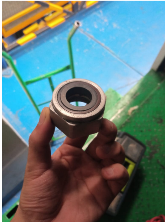
Figura 58: Sección rotatoria del sello mecánico
