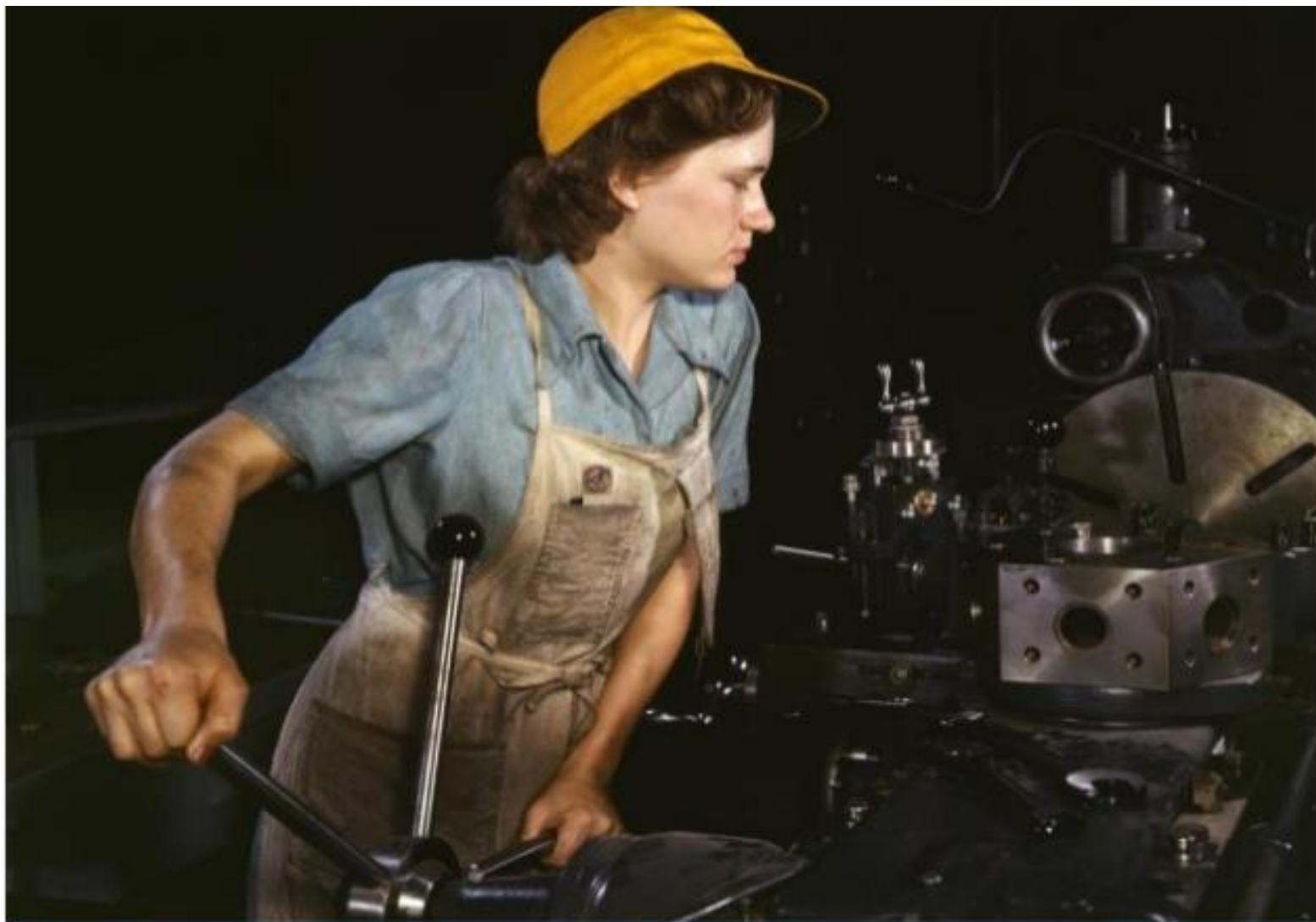
Condición insegura – Iluminación deficiente
