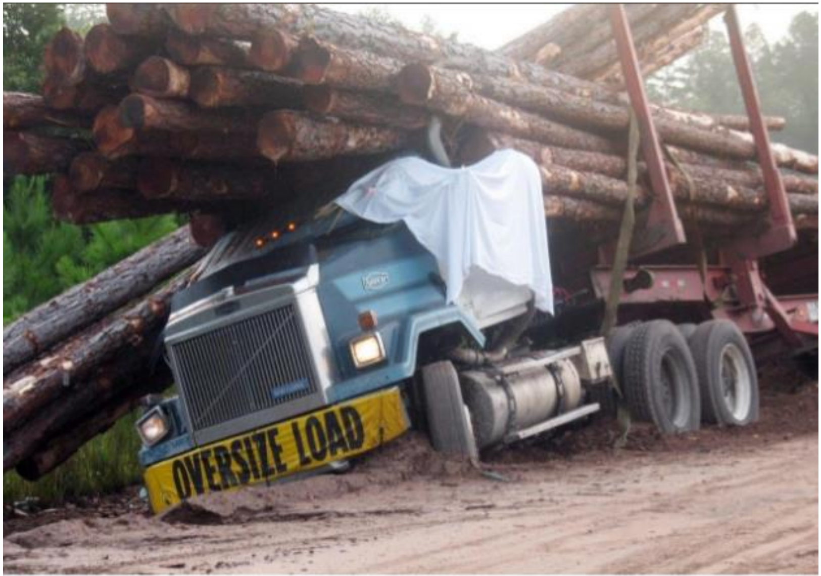
Acto inseguro – Instalar carga de manera incorrecta
