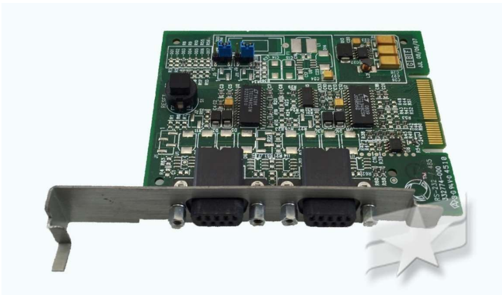
Figura 1 Tarjeta RS232 En consola Veeder Root plus.
