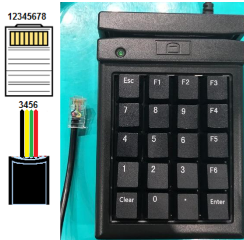
Figura 5. Conector del lector de banda Magnética HCC810.
