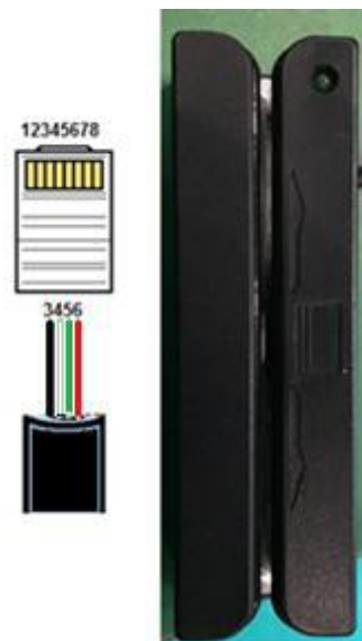
Figura 9. Conector del lector de banda Magnética HCC750R.
