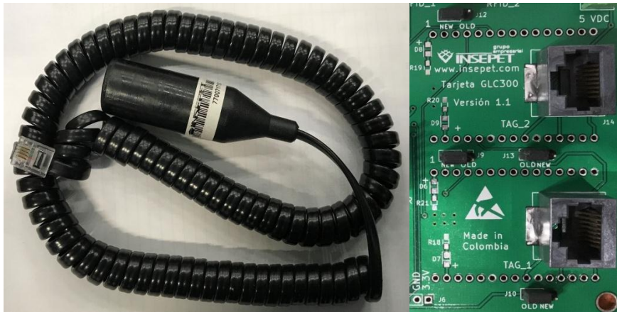
Figura 13. Conector del lector Tag con la Tarjeta GLC300.
