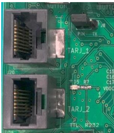
Figura 11. Conector del lector de banda Magnética a la Tarjeta GLC300.
