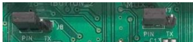
Figura 17. Pin de configuración en la Tarjeta GLC300.
