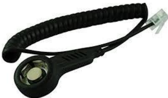
Figura 12. Conector del lector Ibutton con la Tarjeta GLC300.
