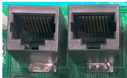
Figura 12. Conector del lector Ibutton con la Tarjeta GLC300.
