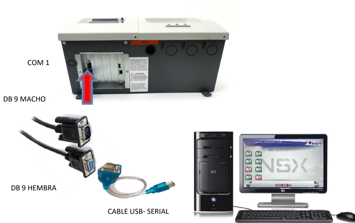
Figura 2. Conexión Nsx y Veeder Root
